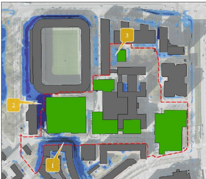
Översiktskarta som visar vattendjup vid skyfall med nya planförslaget. 1 visar vattensamling på Smålandsgatan, 2 visar lågpunkten vid gamla Ullevi, och 3 visar vattensamling i parken mot nya byggnaden
